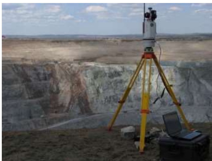
Рисунок 5 – Лазерный сканер с системой спутникового позиционирования
