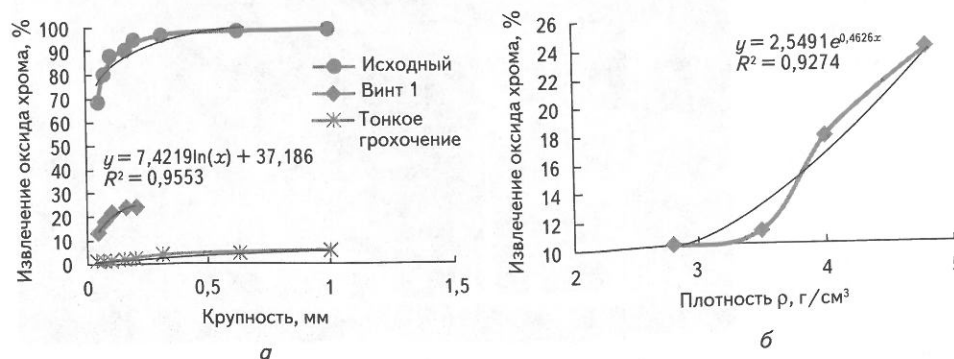
Рис. 4. Сепарационные характеристики продуктов обогащения по крупности (а) и винтового сепаратора 1 по плотности (б)
