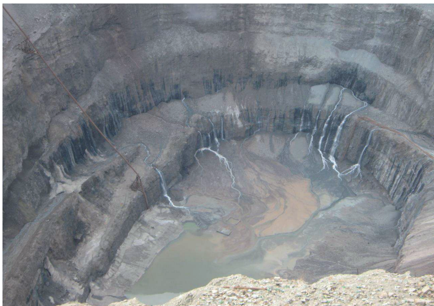
Рисунок 2 – фото дна карьера «Мир» с поверхности земли, с истечением агрессивных вод Метегеро-Ичерского водоносного горизонта 1200 м 3 /час, май 2012г..
