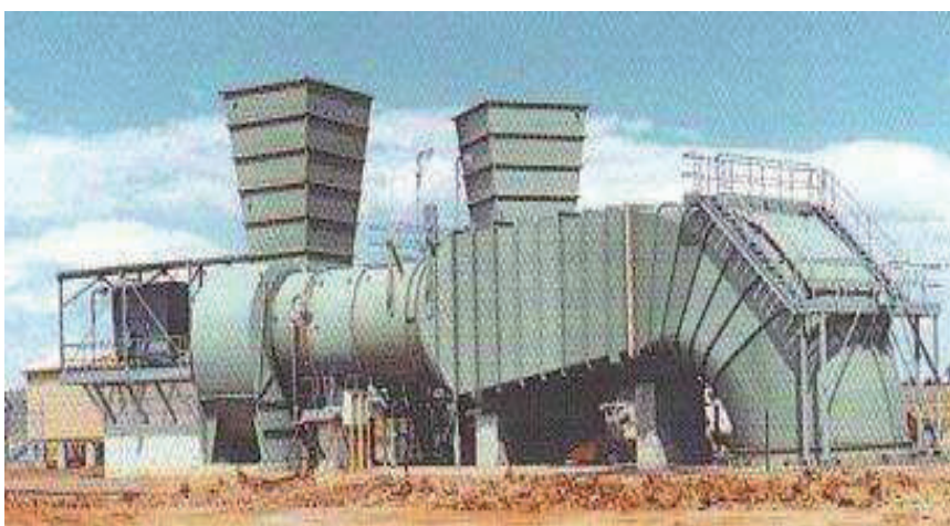
Рисунок 2 – Фото эксплуатации ГВУ для вентиляции подземного рудника без размещения в здании.
