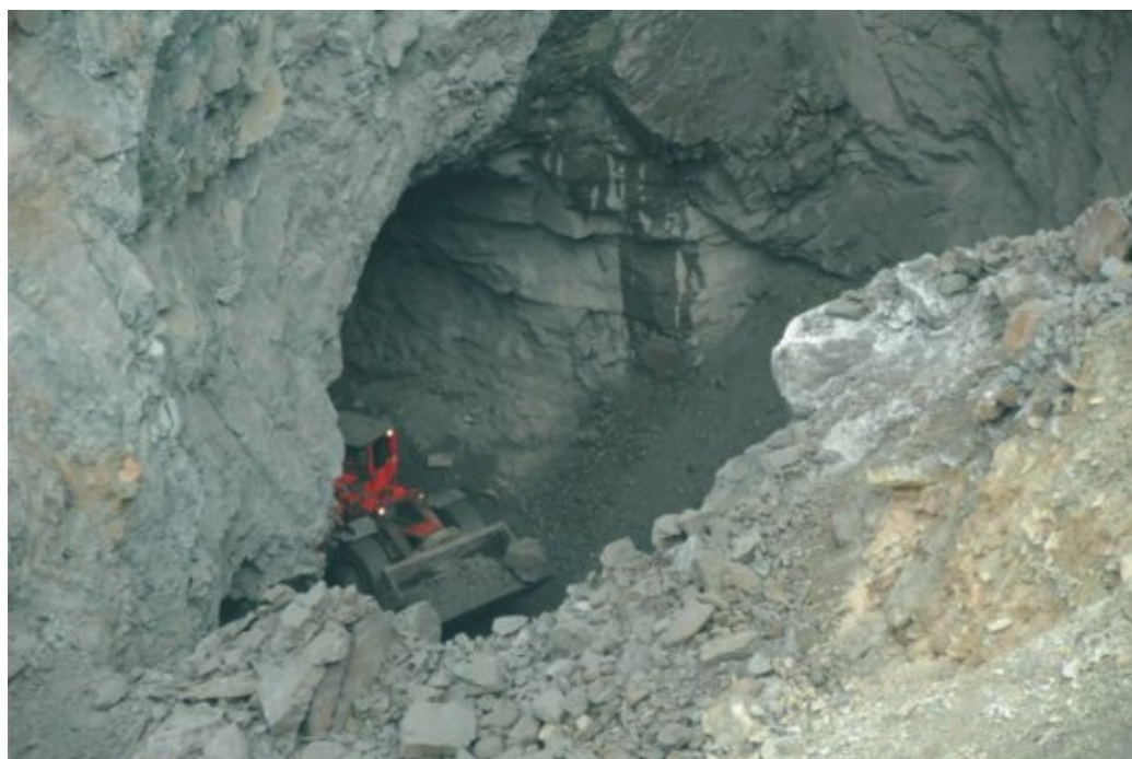
Рис. 3.4.25 и 3.4.26. Работа ПДМ с дистанционным управлением при отгрузке рудной массы из камеры 34-015 (этап 2)
