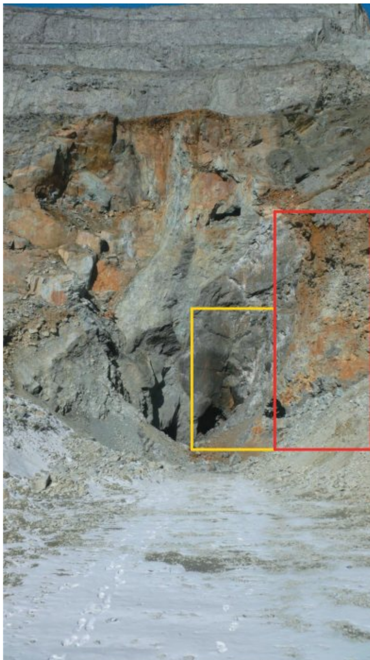
Рис. 3.5.4. Положение горных работ на участке перед отработкой запасов камеры 30-012 (январь 2011 г.). Желтым прямоугольником показана опытная камера 30-012, красным – зона обрушения камеры 34-013. В нижней части фото – поверхность породного отвала, сформированного в подэтаже 300–340 метров, подводящего непосредственно к месту ведения горных работ
