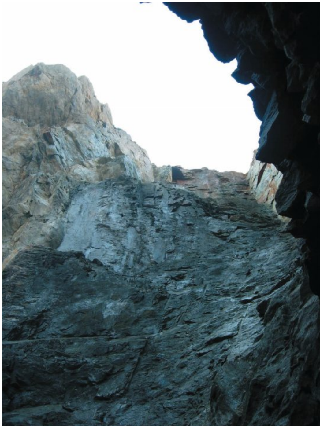
Рис. 3.7.19. Положение горных работ в камере 30-3ю (запасы выше горизонта 300 метров) сразу после отбойки последнего веера в камер 30-3ю (фото сделано из подводящих выработок гор. 300 метров)
