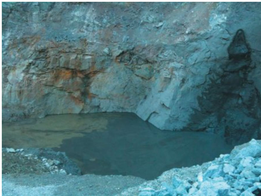
Рис. 3.3.12. Закладка выработанного пространства после выемки придонных запасов разделительного целика (камера К1ПЦС1-240)
