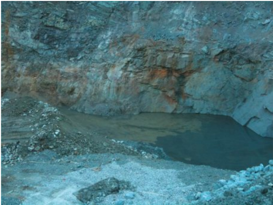
Рис. 3.3.11. Закладка выработанного пространства после выемки придонных запасов разделительного целика (камера К1ПЦС1-240)
