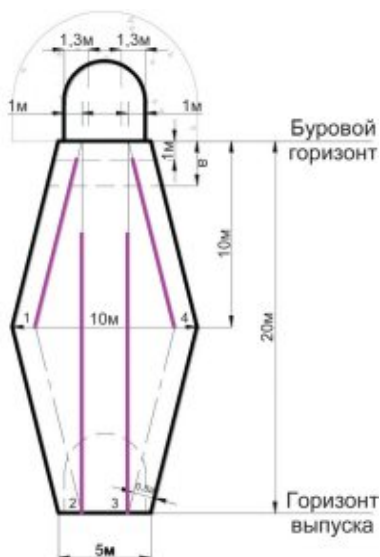
Рис. 5.1.14. Схема разбуривания камер переходной зоны ЮЗРТ (камеры второго типа) при \varnothing скважин 75 мм
