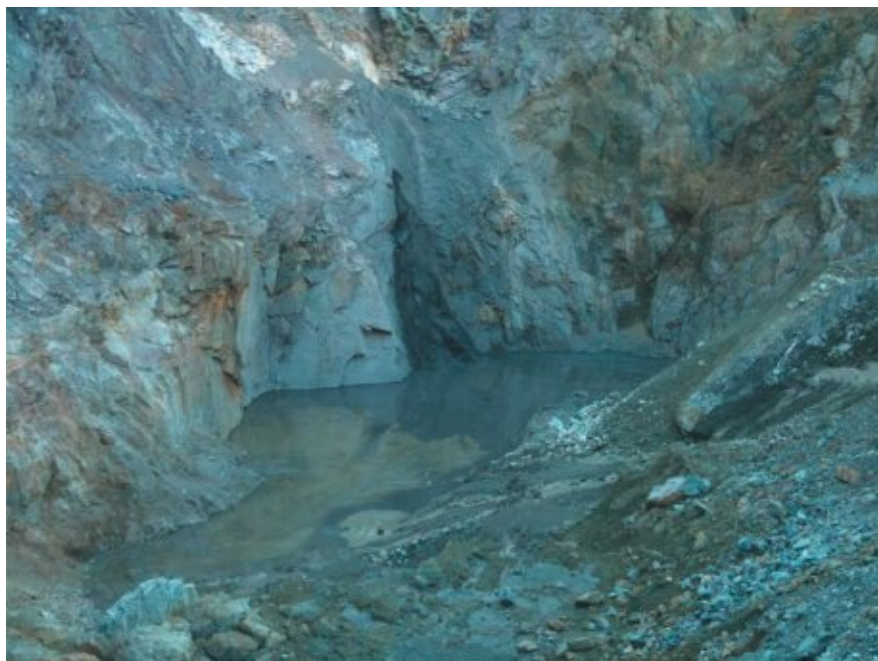
Рис. 3.3.13. Закладка выработанного пространства после выемки придонных запасов разделительного целика (камера К1ПЦС1-240)
