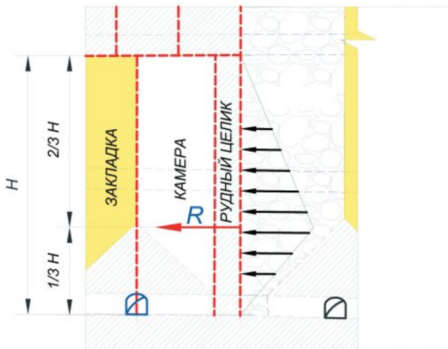
Рис. 2.5.3. Схема к расчету параметров рудного целика с эпюрой действующего на него веса горных пород
