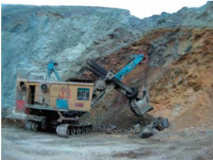
Рис. 3.5.26. Отгрузка руды из зоны обрушения камеры 34-013 (этап № 2)
