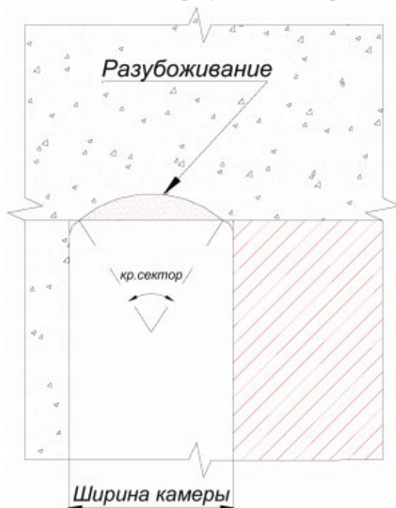
Рис. 2.8.6. Схема к определению потерь отбитой руды на днище камеры при боковых заездах с отгрузкой руды ПДМ без дистанционного управления
