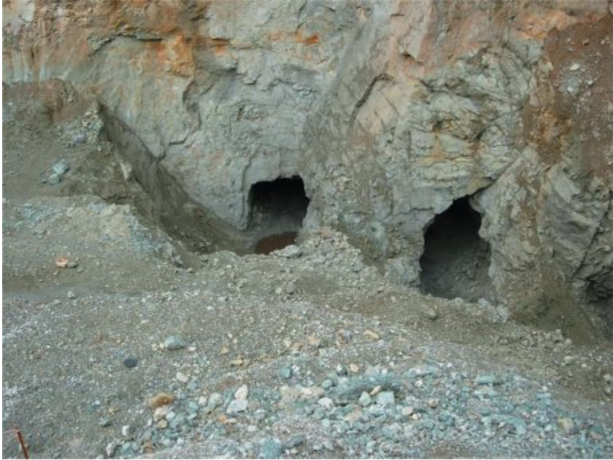
Рис. 3.3.10. Положение горных работ по окончании выемки придонных запасов разделительного целика (камера К1ПЦС1-240)
