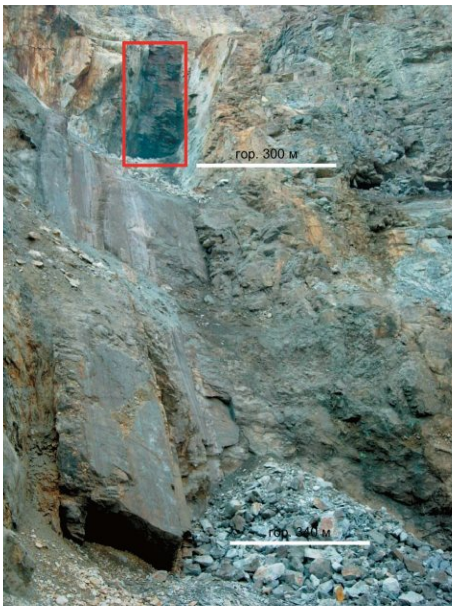
Рис. 3.7.21. Положение горных работ на Южной выclinке Учалинского карьера после отбойки последнего веера в камере 30-3ю (запасы выше горизонта 300 метров)
